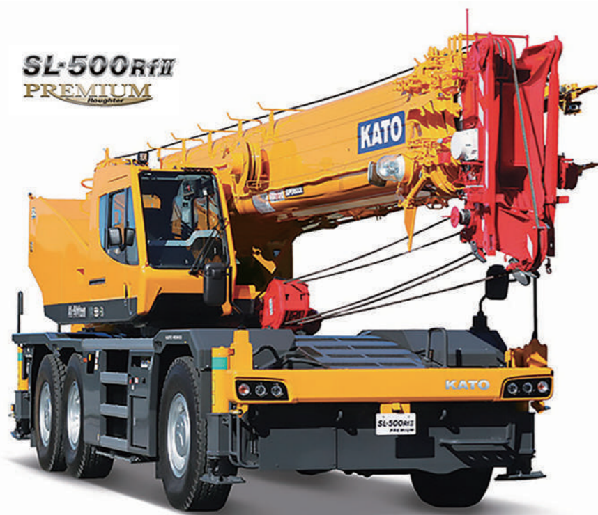
5 段高剛性スーパーブーム採用の「SL-500Rf II PREMIUM」
