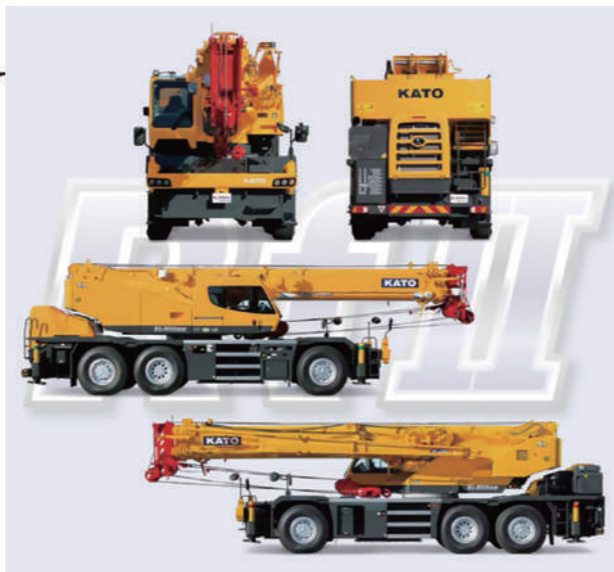
5 段高剛性スーパーブーム採用の「SL-500Rf II PREMIUM」
