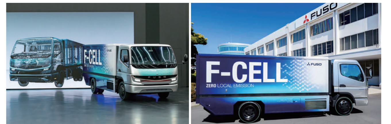
燃料電池トラックコンセプトモデルの「eCanter F-CELL」。満充填は10分以内で完了し航続距離300kmを確保した燃料電池トラックだ
