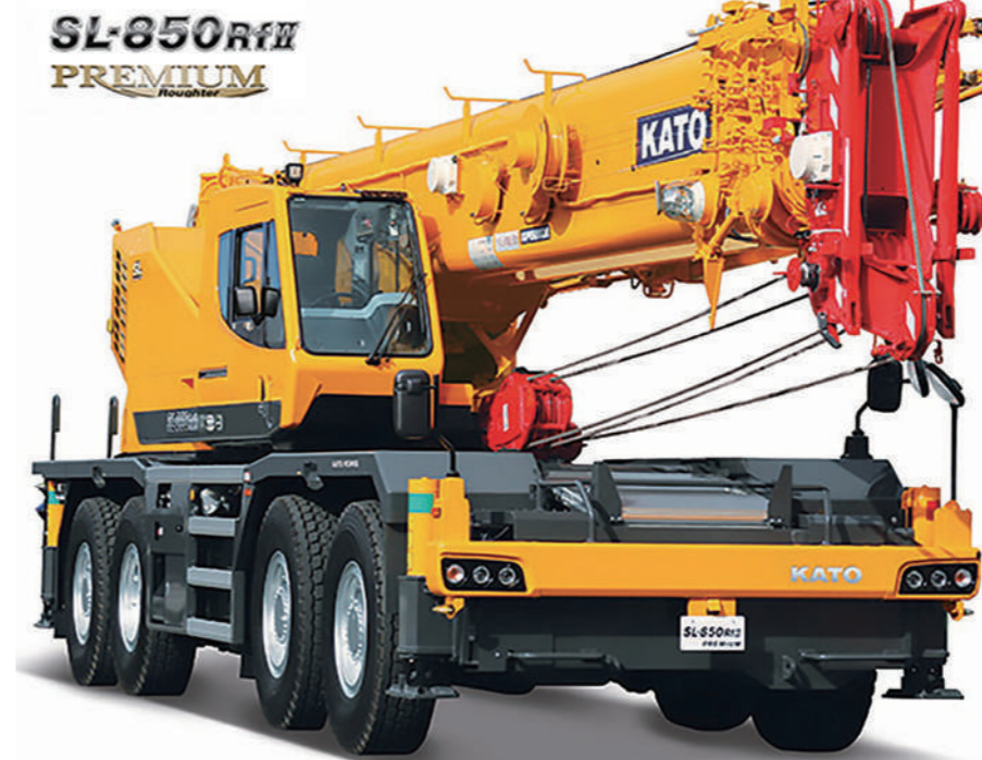
6 段高剛性スーパーブーム採用の「SL-850Rf II PREMIUM」
