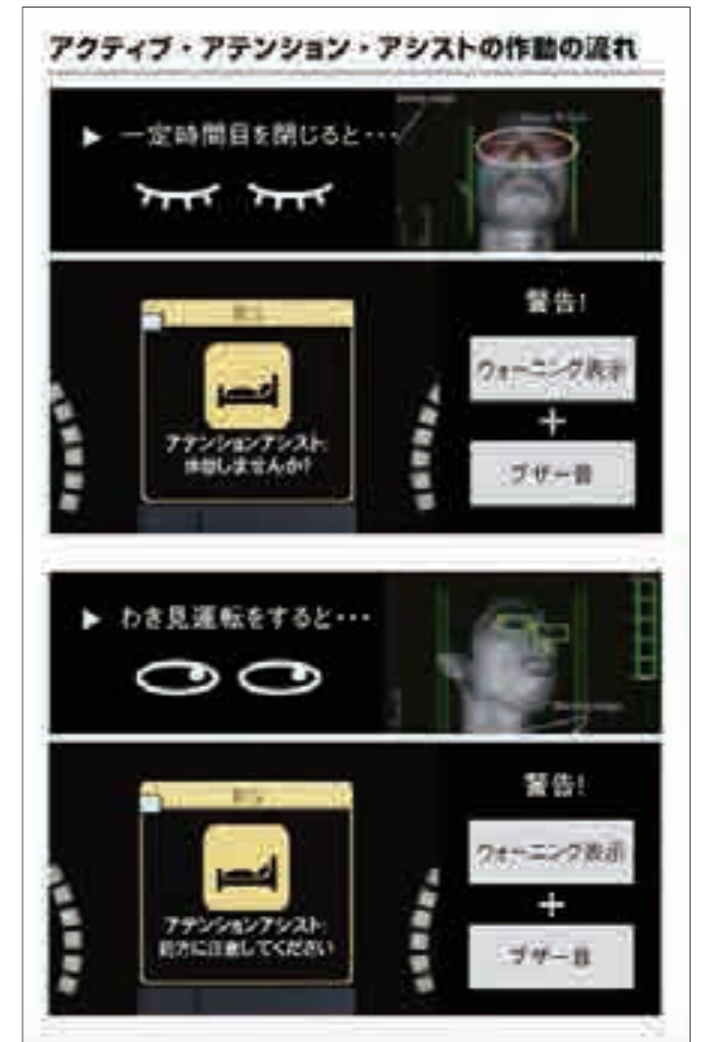
アクティブ・アテンション・アシストの作動の流れ
