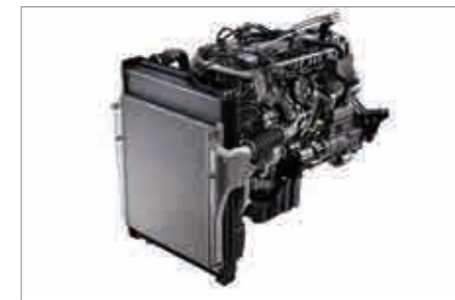
新開発の超軽量 6S10 型エンジン
