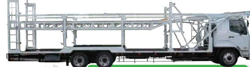
5台積み車両運搬車 (扉レス、側方フォークリフト荷役対応低枠型)
