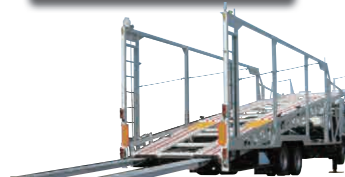
5台積載車両運搬車 (Fジャッキアップ仕様 OP 装着車)
