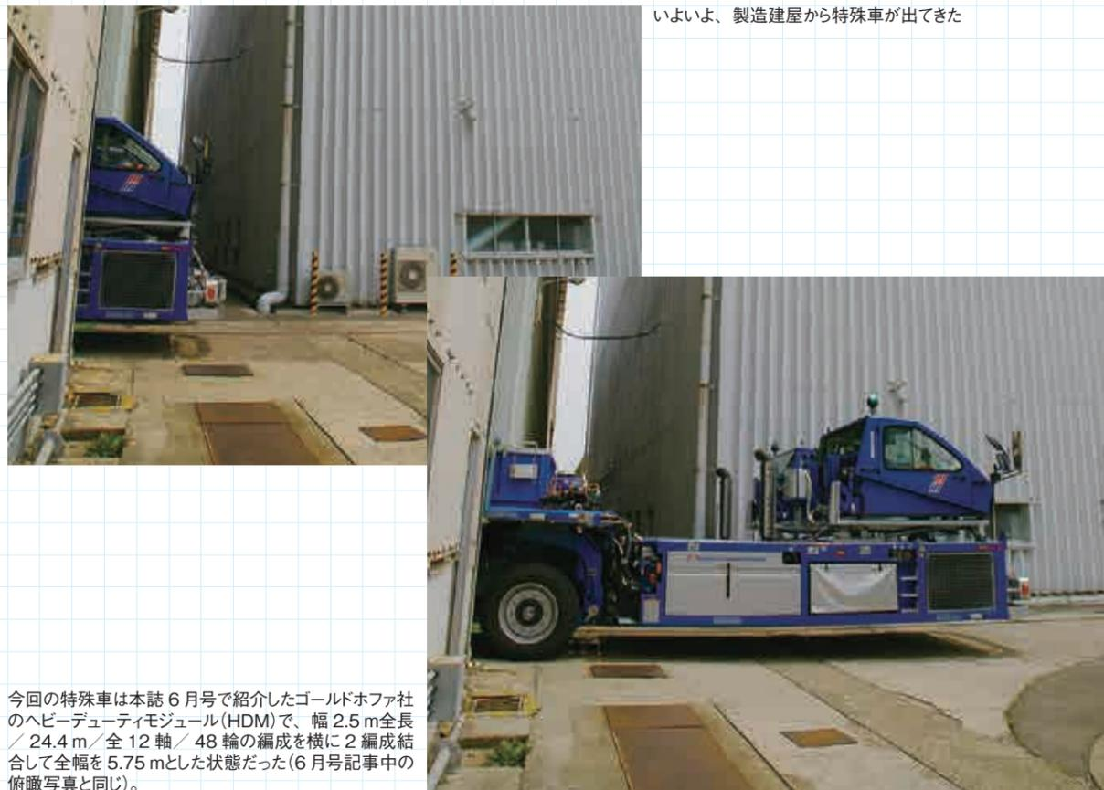
今回の特殊車は本誌6月号で紹介したゴールドホファ社のヘビーデューティモジュール(HDM)で、幅2.5m全長24.4m/全12軸/48輪の編成を横に2編成結合して全幅を5.75mとした状態だった(6月号記事中の俯瞰写真と同じ)。
