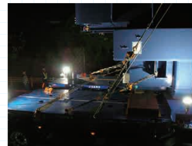
9kmの道中は傾斜(前後・左右方向)もあるから、これだけ大きな貨物で重量もかさみ重心も高いからラッシングも安全最優先で万全を期している。中間地点では10分間の休止時間をもってラッシング状況等の点検も行われた
