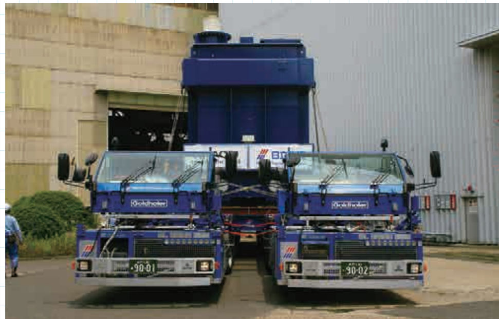
パワーモジュール(PM)上の運転室は左右に2箇所あるが、運転は片側で全ての操作が可能。PMは路面の状況により区部を支点に上下にスウィングして路面との干渉を回避する
