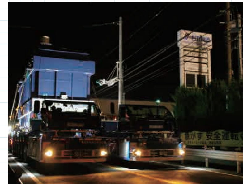
日立物流日立重電営業所前を通過する「今夜の主役」。信号機が干渉を避けて回転させてあるのが判る
