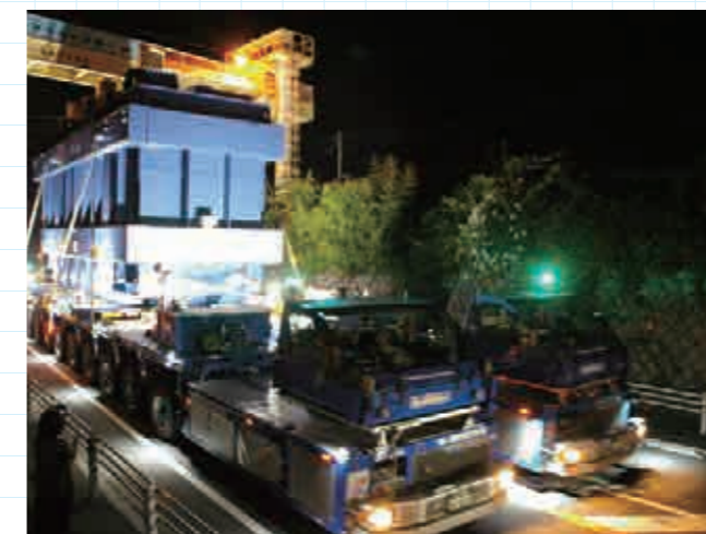
あの歩道橋も無事通過。「今夜の主役」はなお日立港区第四埠頭へ向かって微速運行を続ける。通過後、歩道橋は素早く元の通常の高さに降ろされる
